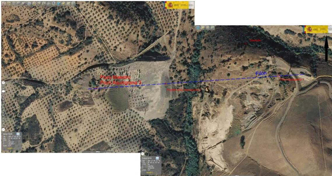
Figura 15. Trazado del filón principal con ubicación de los pozos sobre el mismo.
