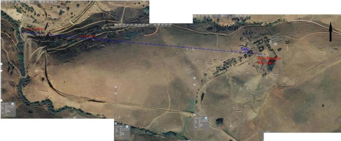
Figura 5. Trazado del filón reconstruido a partir de la ubicación de los pozos
